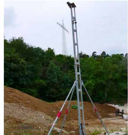
Die Ladung wird von oben optisch erfasst und auf dem Wiegeschein dokumentiert
